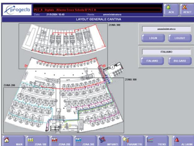
La forma dell'automazione. Una peculiarità dell'impianto, realizzato in una struttura fatta ad anfiteatro, ha inoltre introdotto qualche complicazione "logistica" e di cablaggio: tutte le canaline e i tubi hanno dovuto essere plasmate in forma curva per seguire la disposizione dei serbatoi.
